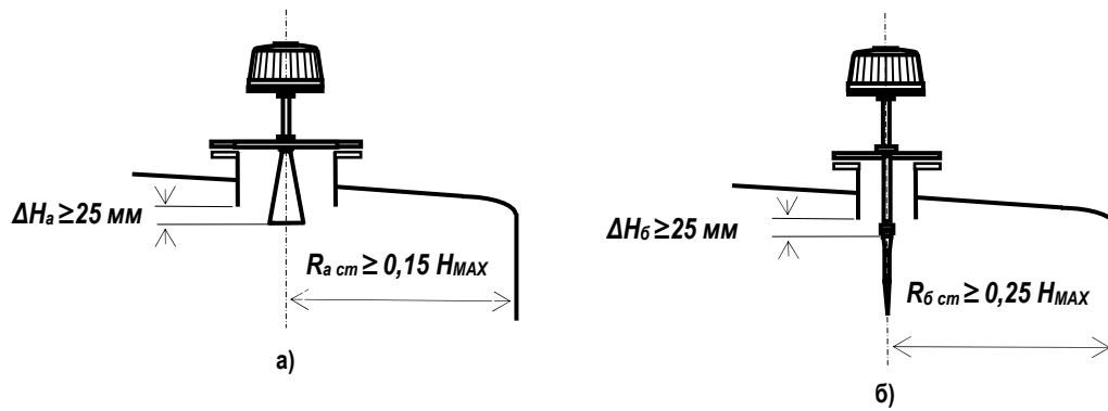
Рисунок 3 - Рекомендуемые варианты монтажа приборов с различными антеннами а) рупорная антенна; б) стержневая антенна ( H_{MAX} – высота резервуара относительно монтажного фланца, в соответствии с рисунком 14; R_{cm} – расстояние от стенки резервуара,)
