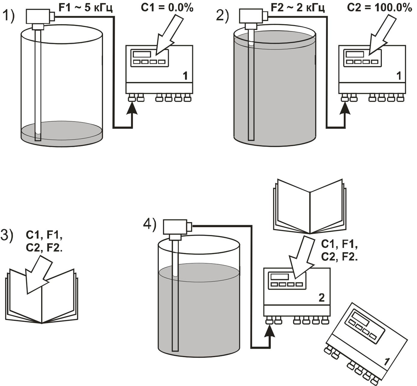
**ВНИМАНИЕ! ЗНАЧЕНИЯ ЧАСТОТ  $F1$  и  $F2$  ДОЛЖЕН ВЫЧИСЛЯТЬ ТОЛЬКО УСТАНОВЛЕННЫЙ НА РЕЗЕРВУАРЕ ПРИБОР. ВВОД ЗНАЧЕНИЙ ЧАСТОТ, ПОЛУЧЕННЫХ ДРУГИМИ СПОСОБАМИ, ПРИВЕДЕТ К ЗНАЧИТЕЛЬНОМУ УВЕЛИЧЕНИЮ ПОГРЕШНОСТИ!**
